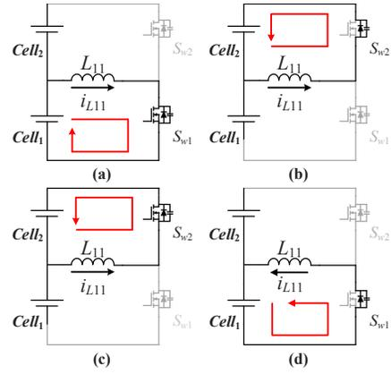
Fig. 3 The equivalent circuit of four modes. (a) Mode 1; (b) Mode 2; (c) Mode 3; (d) Mode 4.
