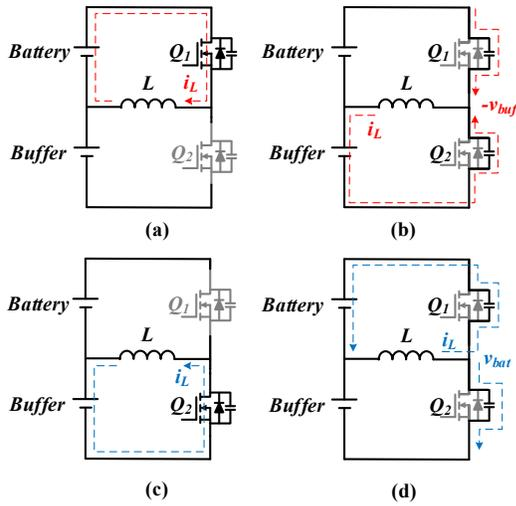
Fig. 4. The current flow of equalizer unit in four sub-intervals. (a)  $t \in [t_0, t_1)$ , (b)  $t \in [t_1, t_2)$ , (c)  $t \in [t_2, t_3)$ , (d)  $t \in [t_3, t_4)$ .
